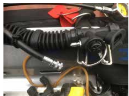
Der Inflater sollte nach jedem Tauchgang abgezogen werden. Er kann sonst verkrusten und im Notfall nicht mehr abziehbar sein.
